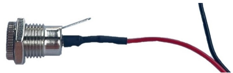
Abb. 5: Fertig zusammengelötete Hohlbuchse
