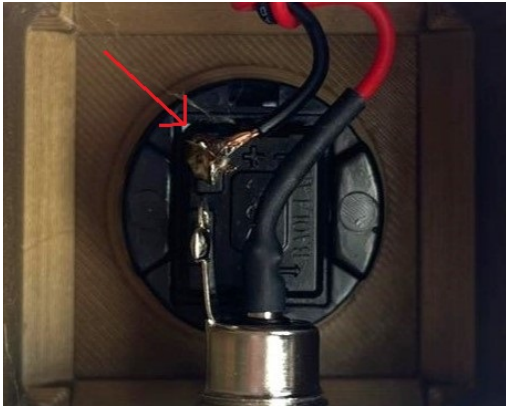
Abb. 7: An den Taster gelötetes Kabel.
