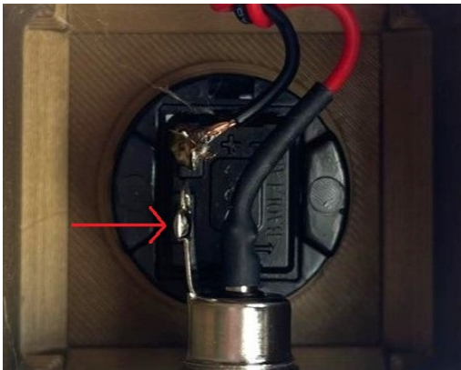
Abb. 8: An den Taster gelötete Hohlbuchse.
