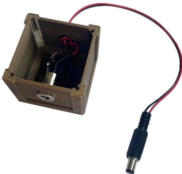
Abb. 13: Fertig zusammengelöteter Taster
