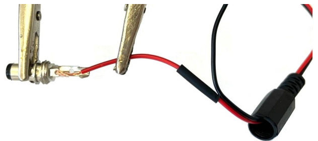
Abb. 9: Löten des Hohlsteckers an das Kabel
