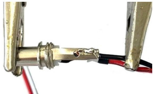
Abb. 10: Löten des Steckers an das Kabel
