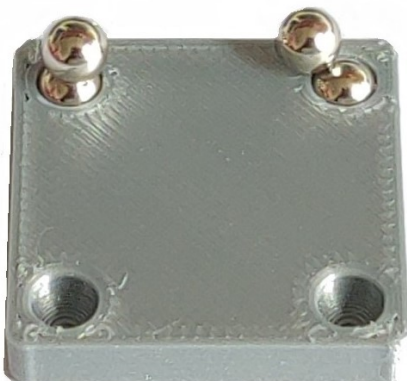
Abb. 8: Mit einer weiteren Magnetkugel lässt sich der passende Sitz überprüfen: Die linke Kugel ist gut ausgerichtet. Die rechte Kugel sollte noch etwas gedreht werden.
