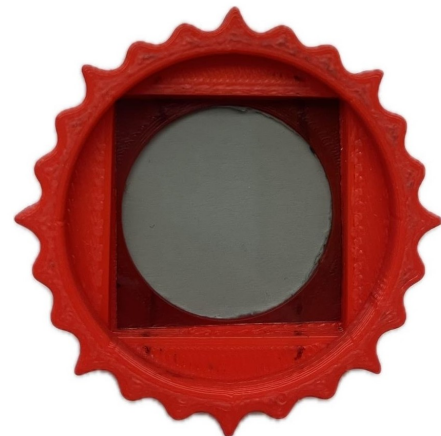
Abb. 5: Polfilterfolie eingelegt in das Drehrad
