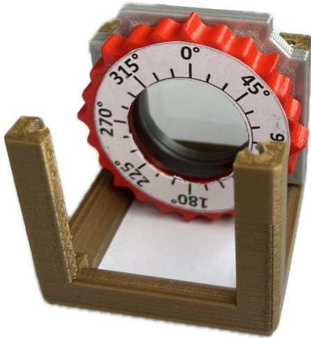
Abb. 11: Halte- und Zwischenplatte mit dem Drehrad im Würfeldeckel
