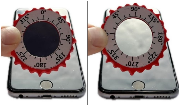
Abb. 6: Polarisation an einer Glasplatte (Brewsterwinkel). Links wird das reflektierte Licht absorbiert, rechts transmittiert.
