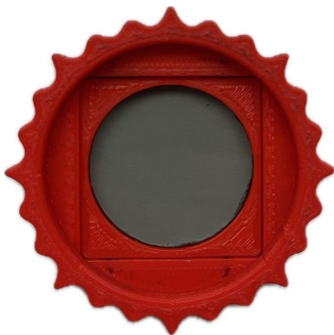
Abb. 7: Im Drehrad befestigte Filterabdeckung
