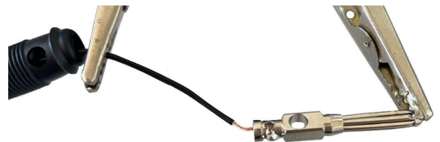
Abb. 13: Löten des schwarzen Kabels an den schwarzen Stecker
