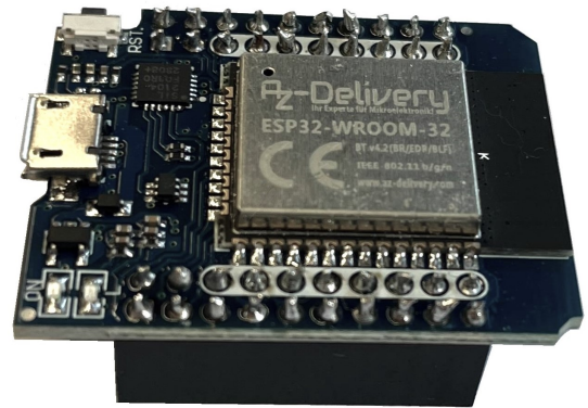
Abb. 4: An die Platine gelötete Stiftleisten
