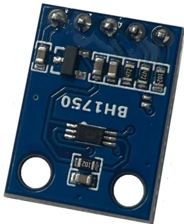
Abb. 6: An den Sensor gelötete Stiftleiste
