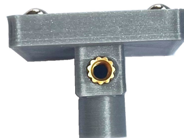
Abb. 9: In die LED-Platte eingeschmolzener Gewindeeinsatz
