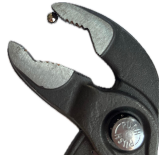
Abb. 7: Magnetkugel an einer ferromagnetischen Zange
