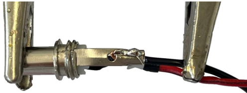
Abb. 17: Löten des Steckers an das Kabel
