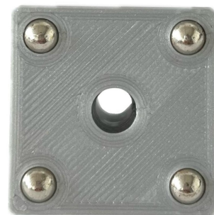
Abb. 8: In die Platte eingedrückte Magnetkugeln
