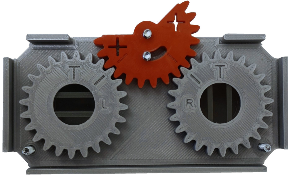
Abb. 12: Korrekt platzierter Schalter
