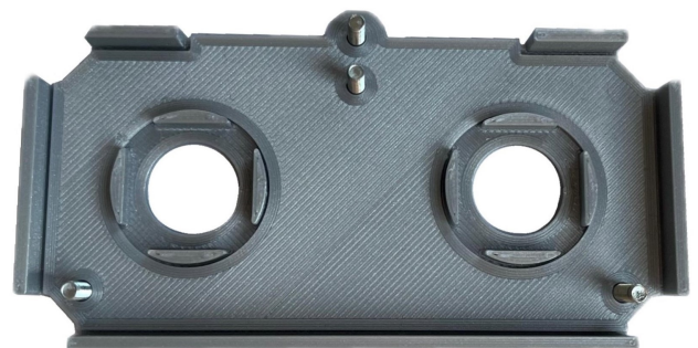
Abb. 10: Durch die Öffnungen der Halte- und Zwischenplatte durchgeschobene Inbus Zylinderkopfschrauben
