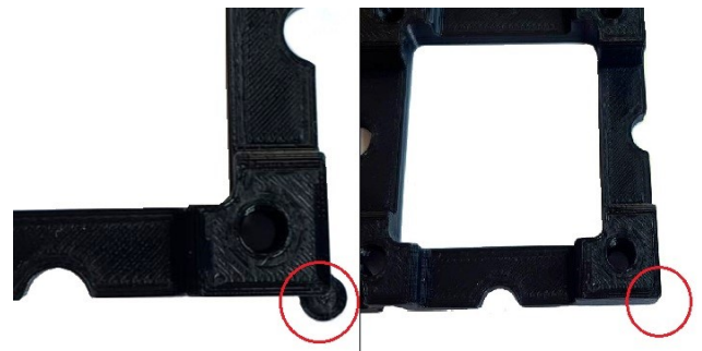
Abb. 5: Ecke der Grundplatte links vor, rechts nach dem Entfernen der Druckreste; die roten Kreise markieren die entsprechenden Stellen
