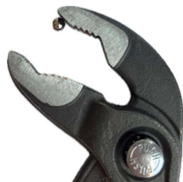
Abb. 7: Die Kugel haftet in der gewünschten Ausrichtung an der Rohrzange aufgrund ihrer ferromagnetischen Eigenschaften
