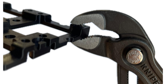
Abb. 6: Eindrücken der Kugeln mithilfe einer Rohrzange
