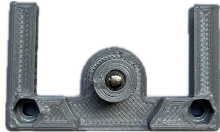
Abb. 4: In den Gitterhalter-Rahmen eingedrückte Magnetkugel
