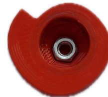
Abb. 11: In den Drehknopf eingeklebte Mutter
