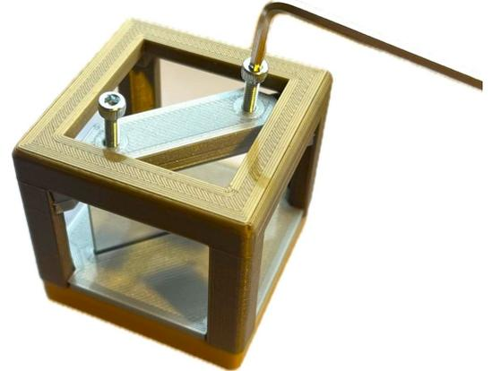
Abb. 13: Befestigen des teildurchlässigen Vorderflächenspiegels
