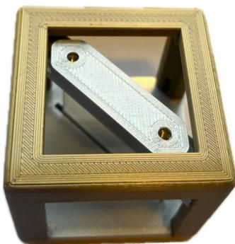
Abb. 12: Zusammengesetzter Strahlteiler ohne Befestigungsschrauben
