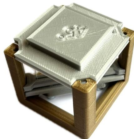
Abb. 9: Vorderflächenspiegel zwischen den beiden Bauteilen eingeklemmt
