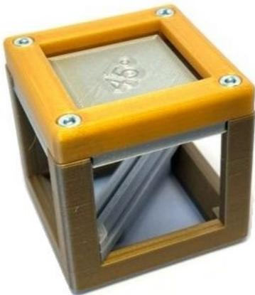
Abb. 11: Zusammengeschraubter Strahlteiler
