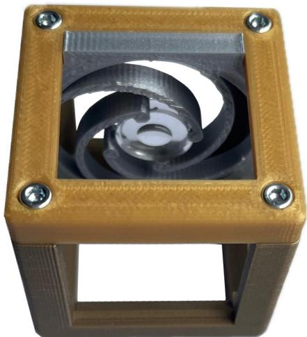
Abb. 8: Zusammengeschraubter Linsen-Würfel
