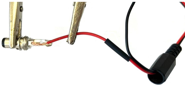
Abb. 15: Löten des Hohlsteckers an das Kabel
