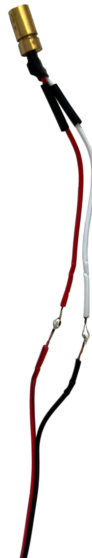
Abb. 13: Zusammengelötetes Kabel mit der Laserdiode
