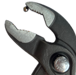
Abb. 7: Magnetkugel an einer ferromagnetischen Zange
