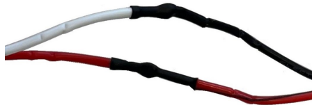
Abb. 14: Schrumpfschläuche über den Lötstellen
