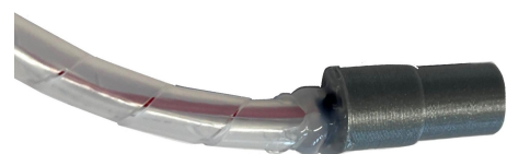
Abb. 20: In die Zugentlastung eingeklebte Laserdiode
