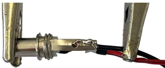
Abb. 16: Löten des Steckers an das Kabel
