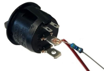
Abb. 5: An den Umschalter gelötetes Kabel und Widerstand
