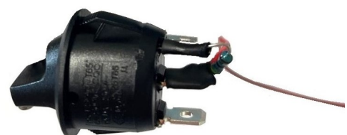
Abb. 7: Angelöteter Widerstand mit Schrumpfschlauch
