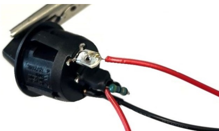
Abb. 10: Korrekt angelötetes Kabel
