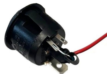
Abb. 6: Korrekt angeschlossener Widerstand
