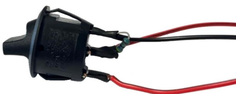
Abb. 11: Fertig zusammengelöteter Umschalter
