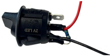
Abb. 9: Schrumpfschlauch über der Lötstelle
