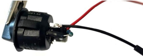
Abb. 8: Korrekt angelötetes schwarzes Kabel
