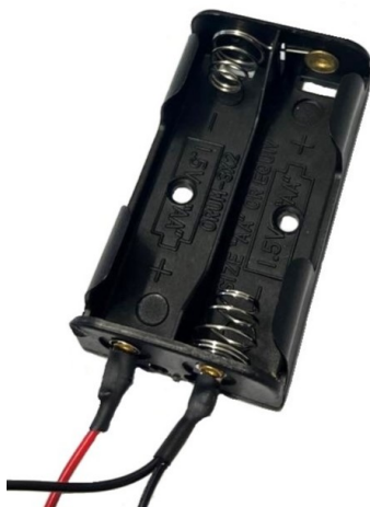
Abb. 16: Fertig angeschlossener Batteriehalter
