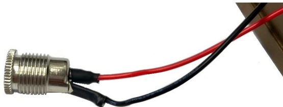
Abb. 20: Korrekt angeschlossene Hohlbuchse
