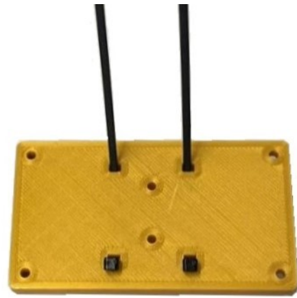
Abb. 22: Kabelbinder in den dafür vorgesehenen Öffnungen des Bodens
