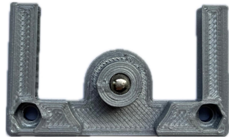
Abb. 4: In den Gitterhalter-Rahmen eingedrückte Magnetkugel
