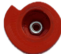
Abb. 11: In den Drehknopf eingeklebte Mutter
