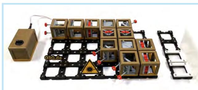
Abb. 11. Das Mach-Zehnder-Interferometer wird um fünf Polarisationsfilter A-E ergänzt (jew. auch erkennbar am roten Rad).
